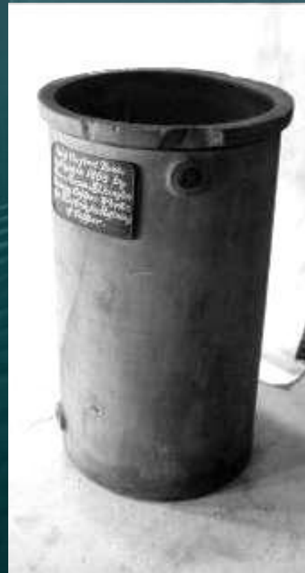
Celda propuesta por Elkington en patente de 1860
