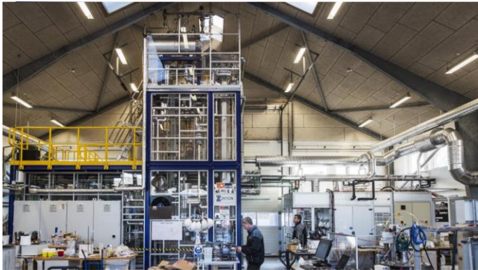
Planta de Metanación Foulum Dinamarca- 50kW SOEC: H 2 +Biogas-> SNG
