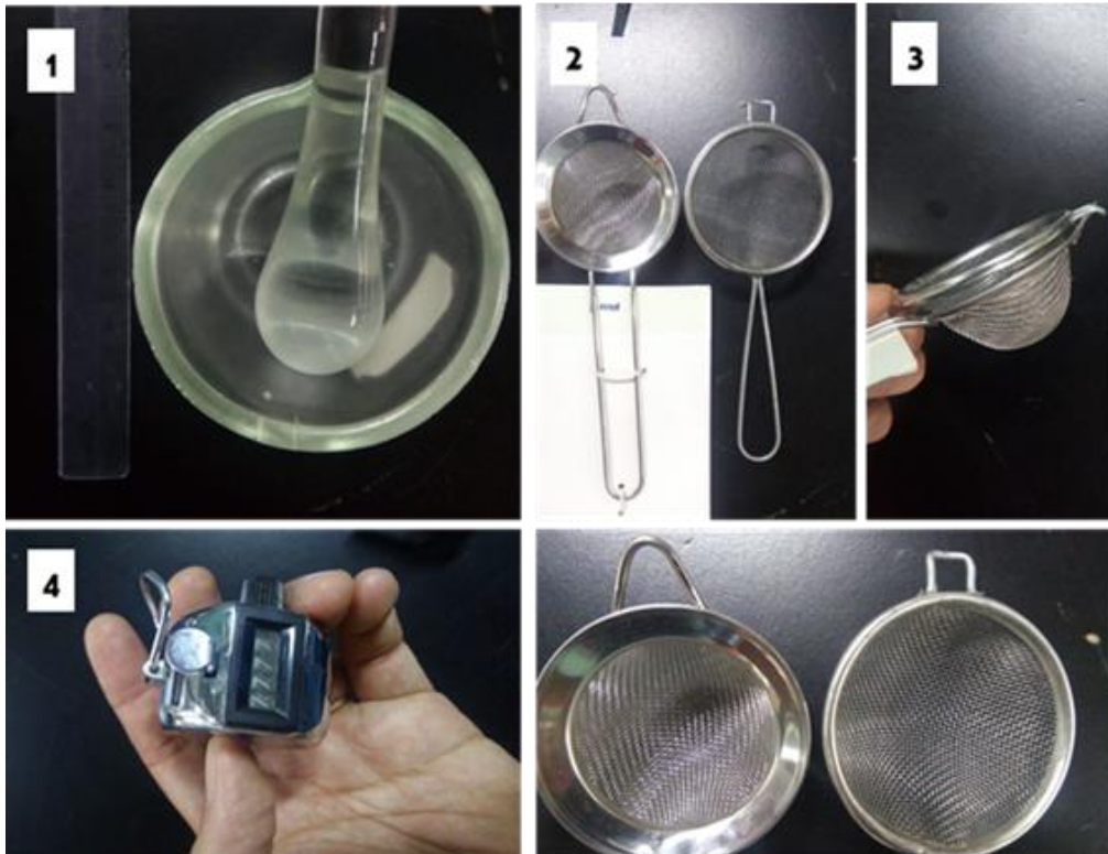
Figura 1. Material necesario para el procesamiento. 1. Mortero con pilón. 2. Filtros/coladores de malla metálica. 3. Filtros acoplados. 4. Contador manual para facilitar el recuento de esporas en microscopio.
