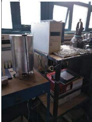
Equipo para mediciones de Reducción y Oxidación programadas TPR/TPO.
